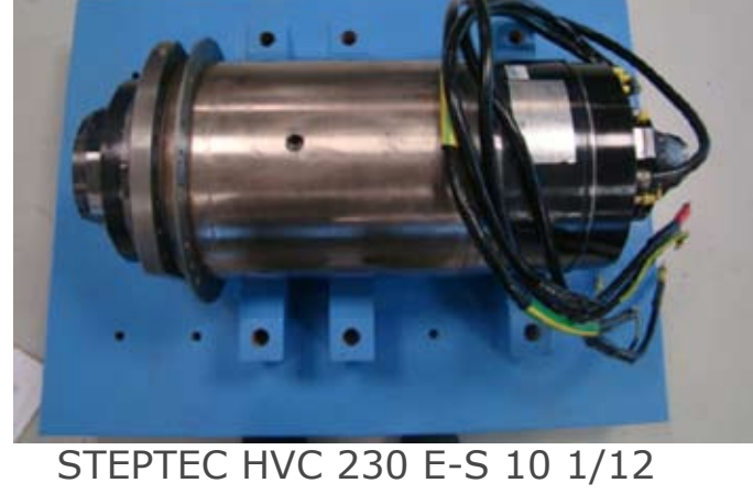
STEPTEC HVC 230 E-S 10 1/12 SK 40 12.000rpm
