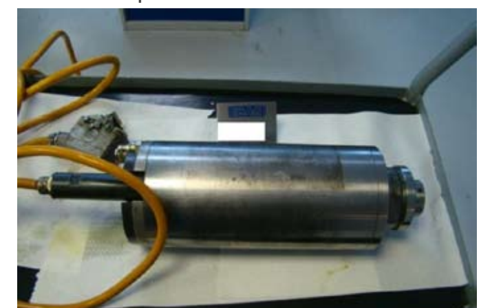
FAEMAT FA 80 CU ISO 20 40.000rpm
