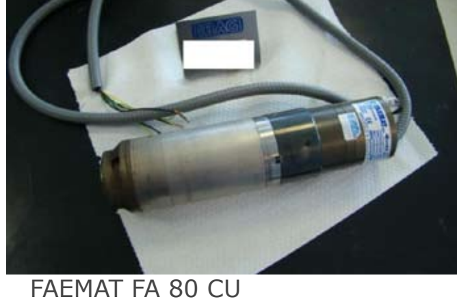
FAEMAT FA 80 CU ISO 20 40.000rpm
