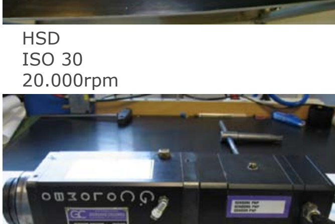
COLOMBO RC73.22 ISO 20 40.000rpm
